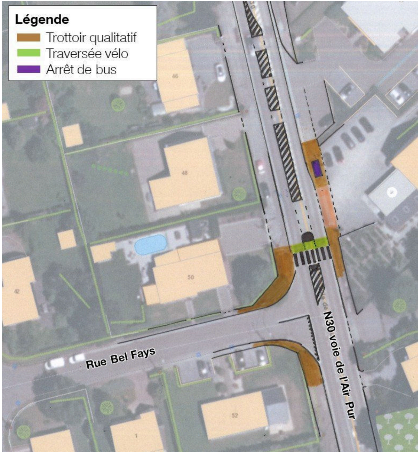
Esquisse proposée pour sécuriser les accès cyclables et aux bus au niveau de la rue de Bel Fays.
